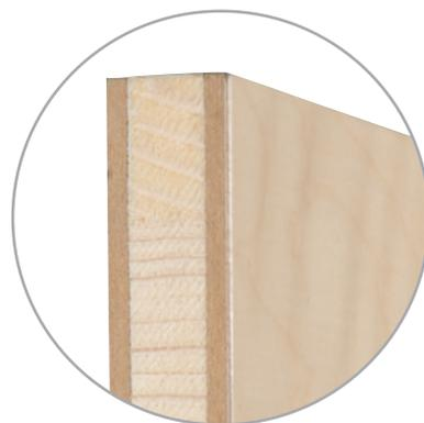
Ces panneaux en véritable bois de bouleau se distinguent des panneaux de particules (qui se composent de grands copeaux pressés sur plusieurs couches) et des panneaux en MDF (obtenus à partir de sciure compressée) par une stabilité inimitable : les assemblages techniques des meubles sont nettement plus stables et durables.
